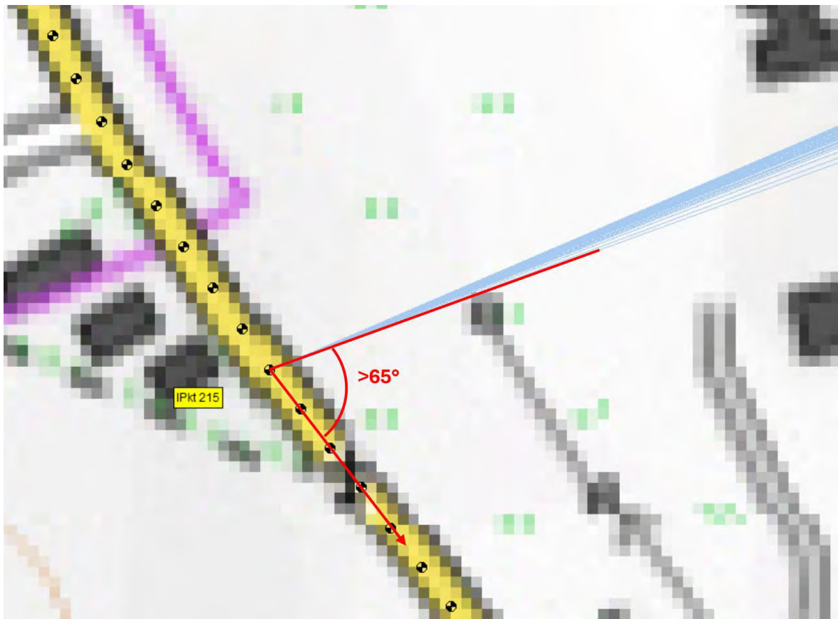
Abbildung 5: Exemplarische Darstellung der Reflexionen auf IPkt 215 am Beispiel in Fahrtrichtung Süd
