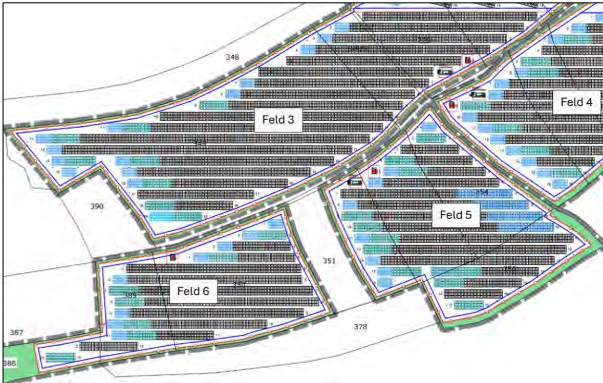
Abbildung 3: Auszug aus dem Modullayout „Hohenwart I“ (Feld 3 + 5 + 6), Planstand vom 21.01.2026, Planzeichner: Anumar GmbH
