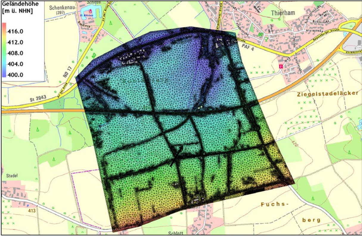
Abbildung 4-2: Darstellung von Netzstruktur und Geländehöhe des 2D-Modells; Hintergrund: Topografische Karte © LVG Bayern
